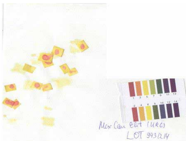
Рис. 1. Визначення рН неpolімеризованого композитного цементу «Maxcem Elite» («Kerr Dental», USA) за допомогою універсального індикаторного паперу
